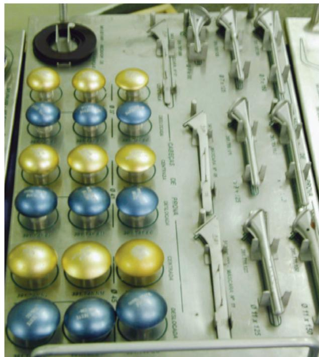
**Figura 2.** Cabeças e hastes intercambiáveis para teste.
